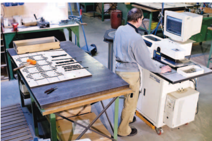
Präzisionstechnik für das automatische Ablängen und Biegen von Bandstahl erhöht Standzeit und Produktivität der Stanzformen.
